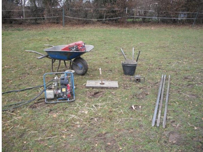
Schubkarre, Bohrhämmer, Ziehgerät und Kernsonden
